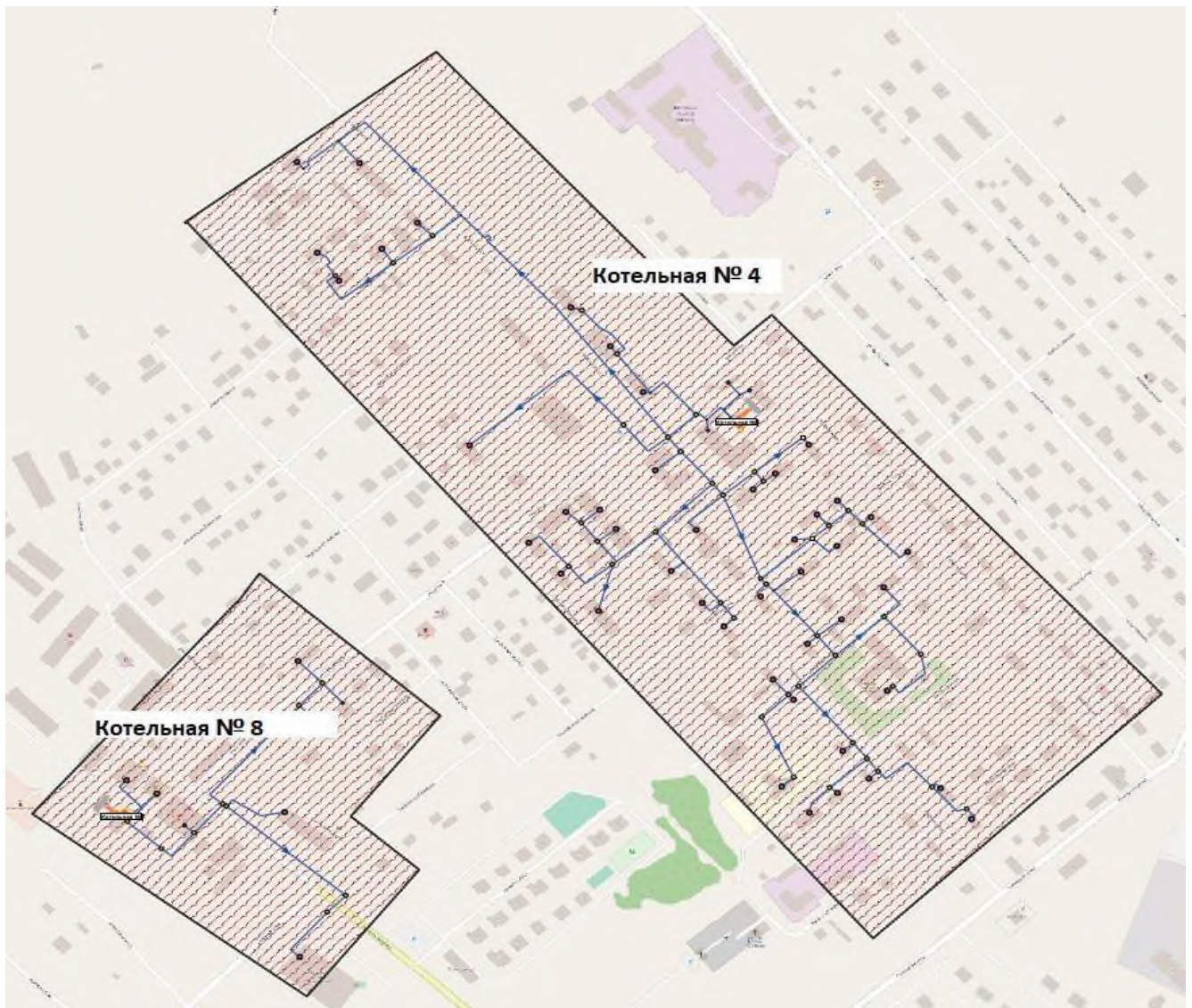
Рисунок 1.1.5-2 – Зоны действия котельной №4, котельной №8
