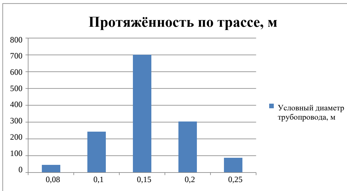
Рисунок 3.1-7 – Структура тепловых сетей котельной №12
