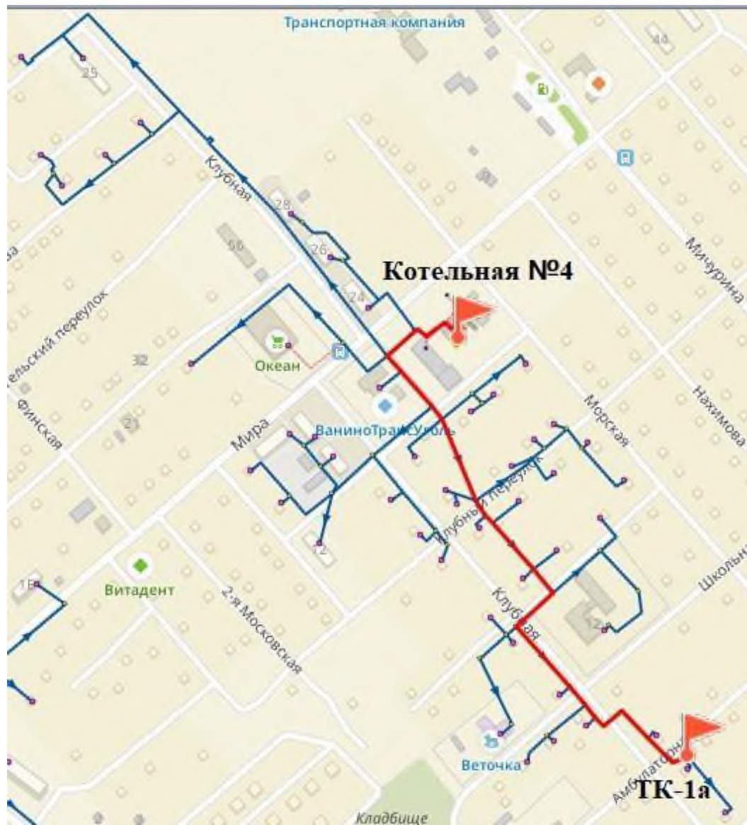
Рисунок 3.9-19 – Участок от котельной №4 до ТК-1а для построения пьезометрического графика
